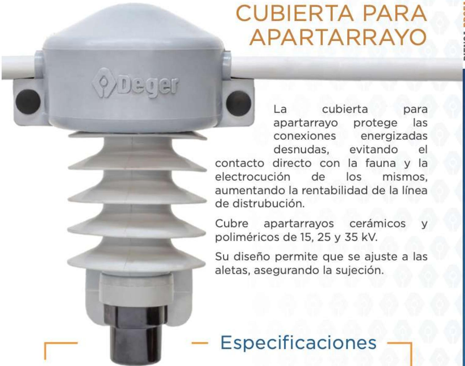
La cubierta para apartarrayo protege las conexiones energizadas desnudas, evitando el contacto directo con la fauna y la electrocución de los mismos, aumentando la rentabilidad de la línea de distribución.
